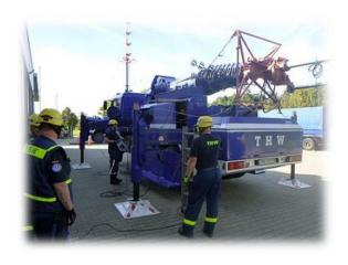
Die Teilnehmer konnten hier an zwei im THW eingesetzten Typen von Mastkraftwagen (MastKW) ausgebildet werden. Eine Mastanlage auf einem Mercedes Fahrgestell kann stufenlos von 12m bis 40m über Grund ausgefahren werden.
