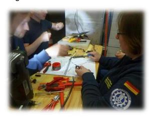
mit Quetschverbindern werden die Adern in eine Steckhülse geschoben und mit einer Quetsch- oder Crimpzange festgedrückt.
