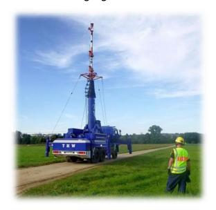
Im Gelände mussten hierzu die Stützen ausgefahren und der Mast aufgerichtet werden. Die Teilnehmer hatten nun das Einsatzfahrzeug in diesem Zustand durch das Gelände zu führen. Eine nicht alltägliche Aufgabe, die im Einsatz jederzeit vorkommen kann.
